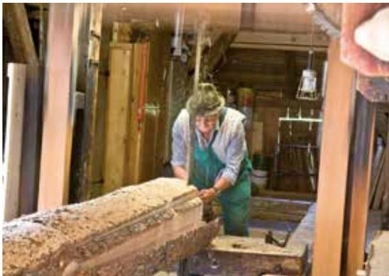
einem so genannten Venezianergatter aus Teilen einer Säge in Frastanz. Im gemauerten Untergeschoss befindet sich das ober-schlächtige hölzerne Wasserrad (Durchmesser 4,1 m), welches in der Radstube die Transmission antreibt. Diese sorgt über zwei exzentrische Schwungräder und die Stelzen für die Auf- und Abbewegungen des Venezianergatters, einem einfachen senkrechten Sägeblatt mit automatischem Vorschub. Über eine Handwinde werden die Baumstämme seitlich auf den Blochwagen geholt.
